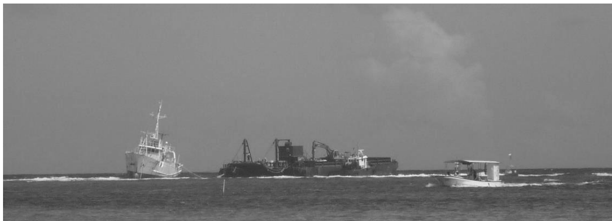
台船1,500 tを横付けして油抜き取り作業中、その横でグラスボートは観光案内営業中
