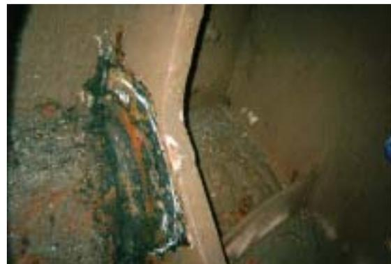
Photo.4 座屈した内部構造部材
