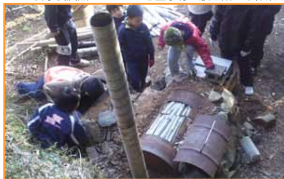
自家製炭窯にびっしりと孟宗竹を敷き詰める作業↓
