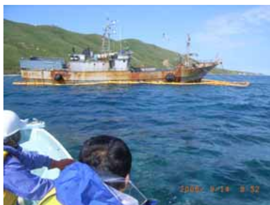
座礁船周囲に漁協が展張したオイルフェンス
